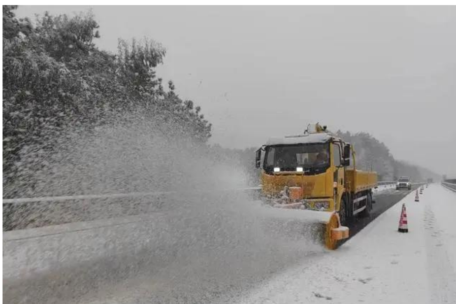
高速养护队伍正在进行滚刷除雪
